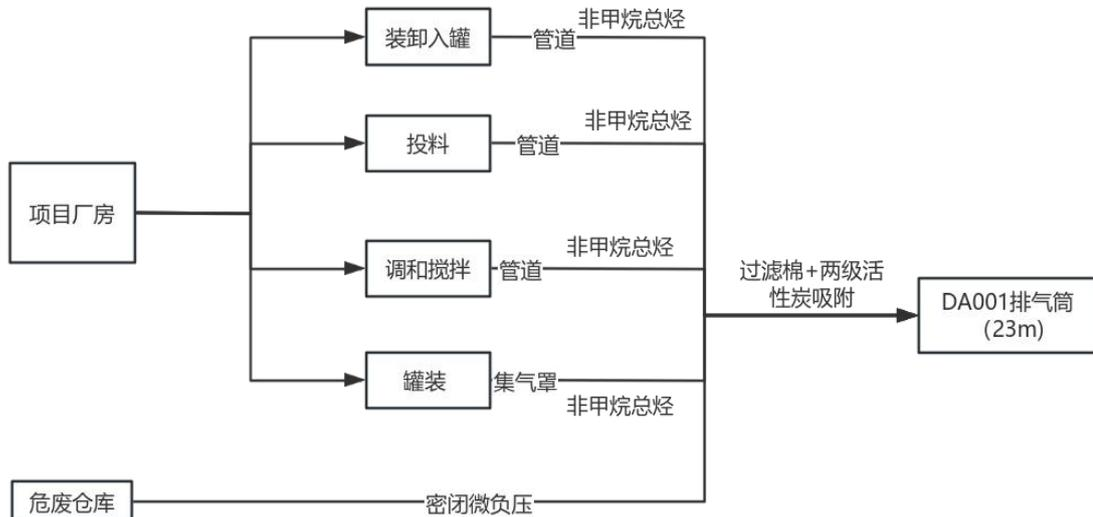
图4.1-1 废气治理工艺流程图
