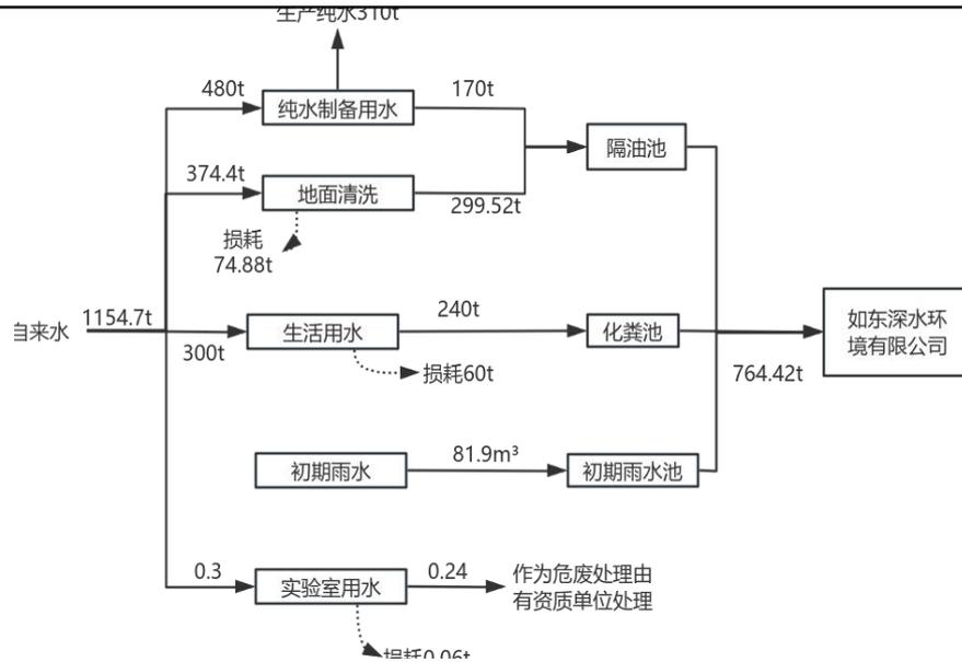
图2-2 本项目水平衡图 (t/a)
