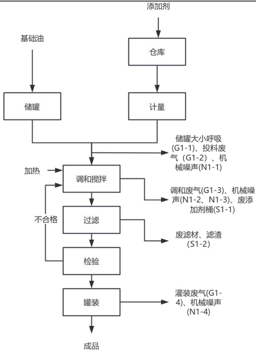
图2-3 润滑油调和工艺流程图
